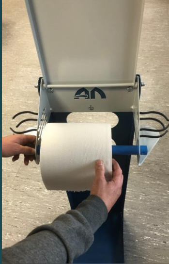
Mise en place du rouleau sur son dévidoir
